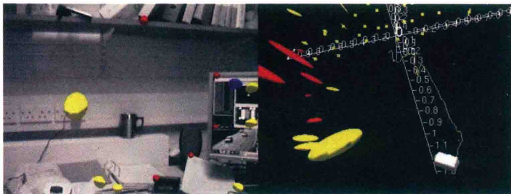
图14-1 MonoSLAM 的运行时截图。(a) 追踪特征点在图像中的表示；(b) 特征点在三维空间中的表示
