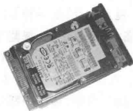
图 1-6 硬盘的外部结构
