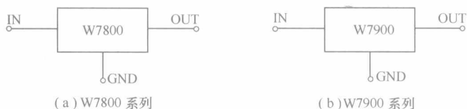
图 1.1.5 W7800 系列和 W7900 系列三端集成稳压器的电路符号
