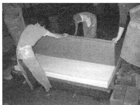
图 1-11 揭帘——将捞出的湿纸移置到湿纸堆上，一起榨干
