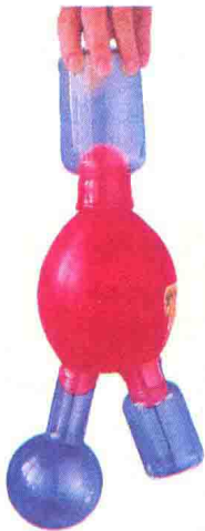
图9 用开水把杯子烫热，立即扣在气球上，气球能把杯子“吸”住。这说明了什么？
