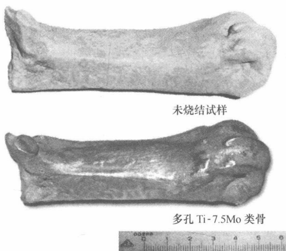
图 1-4 凝胶注模法制备的类骨多孔钛材料 [22]
