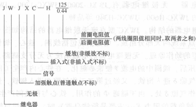
图 2-3 安全型继电器表示法
