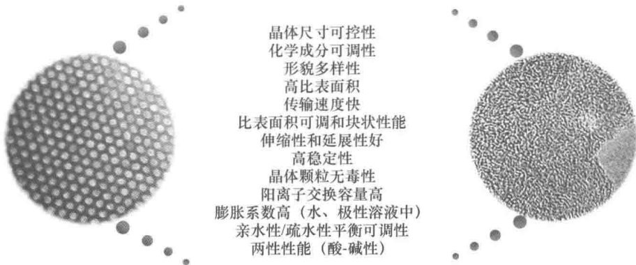
图 1-2 微孔和介孔纳米材料的重要性能
