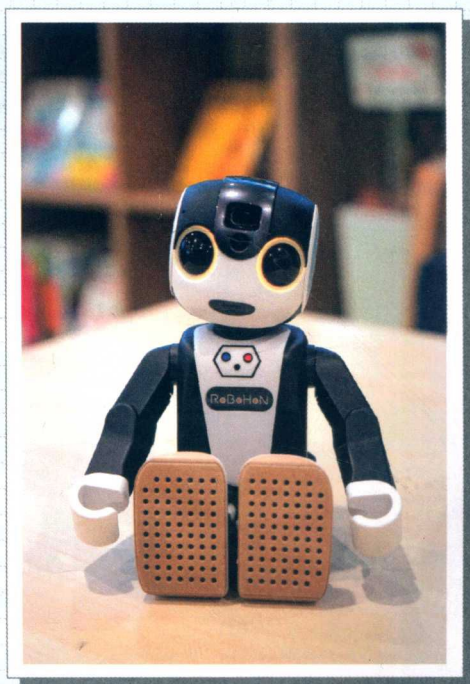
图1-8 夏普公司的机器人RoBoHoN 搭载了Android操作系统，是具有智能手机和投影仪功能的小型机器人
