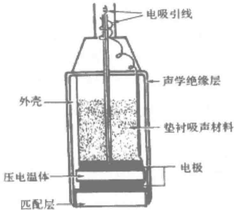
图 1-8 单晶片探头结构
