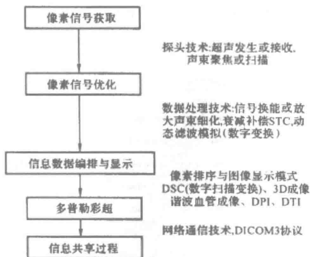
图 1-2 超声图像生成过程与相关技术框图
