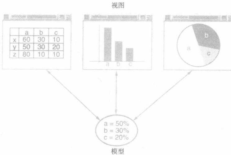
表面上看，这个例子反映了将视图和模型分离的设计，然而这个设计还可用于解决更一般的问题：将对象分离，使得一个对象的改变能够影响另一些对象，而这个对象并不需要知道那些被影响的对象的细节。这个更一般的设计被描述成 Observer(5.7) 模式。
