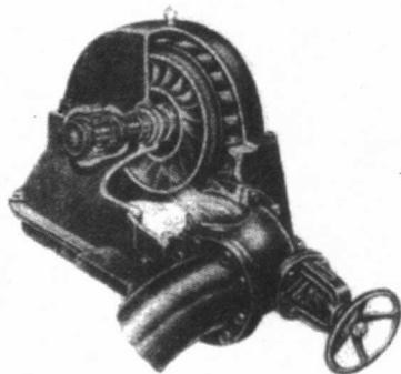
图 1-2 斜击式水轮机
