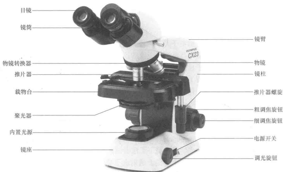
图 1-1 光学显微镜结构示意图
