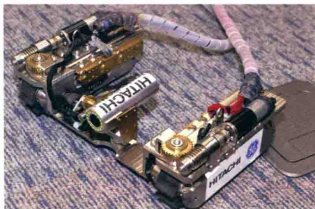
图 4 Hitachi 蛇形机器人的内部结构
