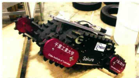
图 6 Sakura 机器人被设计用来爬过废墟以查看反应堆建筑的损坏情况
