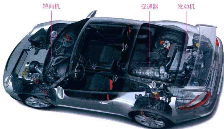
图 1.2-2 汽车结构视图（后置发动机）
