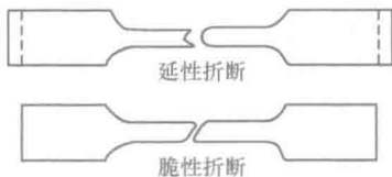
图 1-4-2 脆性材料与延性材料的断裂面
