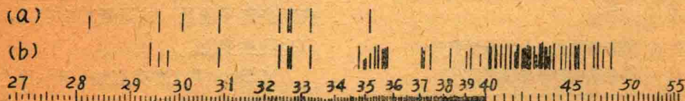
图7 Sullivan-Walsh辅助输出铜空心阴极灯的光谱与普通铜空心阴极灯的光谱比较 [57] 。 (a) 辅助输出阴极灯，曝光2秒；(b) 普通阴极灯，曝光5分钟
