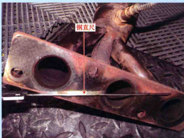
检查排气歧管的平面度
