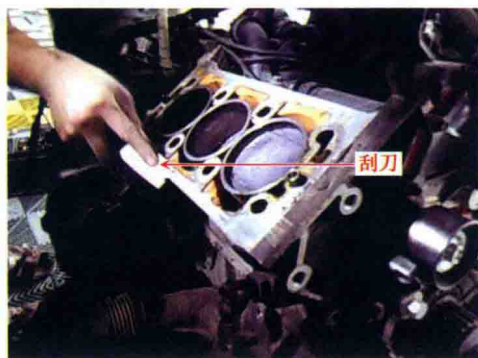
用刮刀清理气缸体表面
