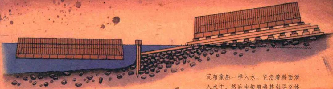
沉箱像船一样入水。它沿着斜面滑入水中，然后由拖船将其引导至修建桥柱的具体地点，再下沉至水底。
