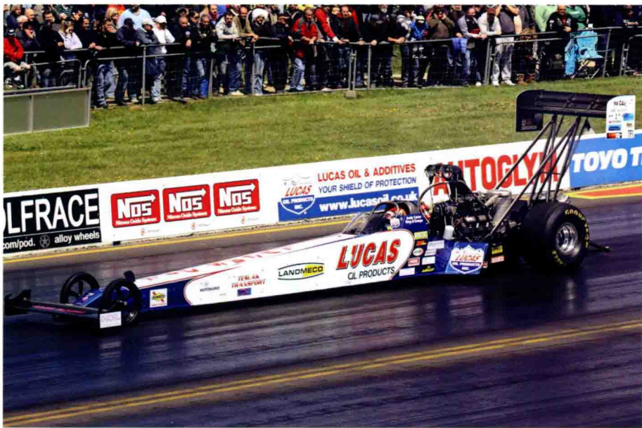
在流行于美国的Top Fuel改装车直线加速赛中，0—160千米/时的加速时间最快只需0.86秒，按照上页介绍的G值计算方式，其纵向加速度G值高达 5.3g
