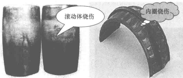
图 1-4 某航空发动机轴承烧伤（源自网络）
