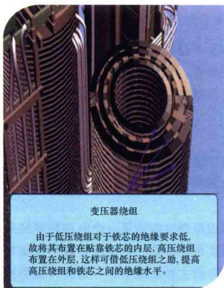
图 1-2 变压器绕组排列方式
