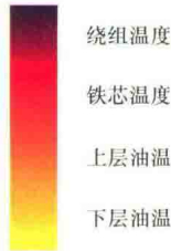
图 1-4 变压器温度示意图
