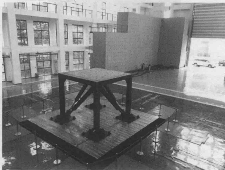
图 2.3 重庆大学 6.1\text{ m}\times 6.1\text{ m} 振动台
