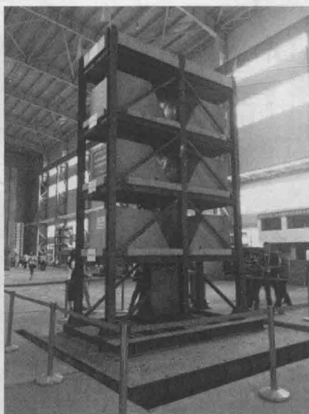
图 2.4 西安建筑科技大学 4.1 m×4.1 m 振动台
