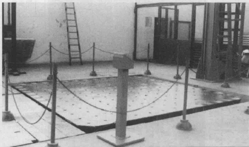
图 2.2 同济大学 4.0 m×4.0 m 振动台
