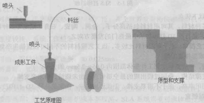
图 1-4 FDM 打印原理
