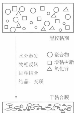
图 1-2 水性胶黏剂的粘接机理
