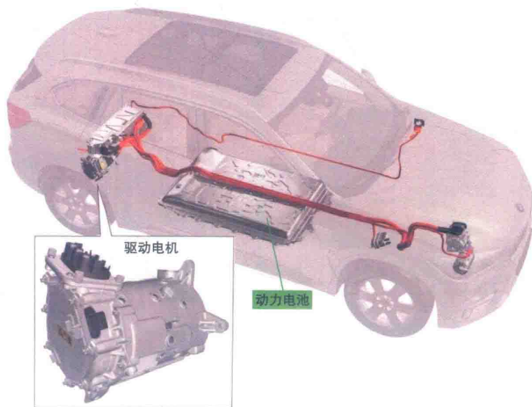
图 1-2-2 宝马 X1 PHEV 驱动电机安装位置
