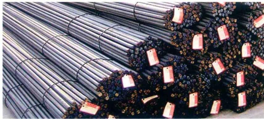
图1-11 钢筋进场堆码、挂牌
