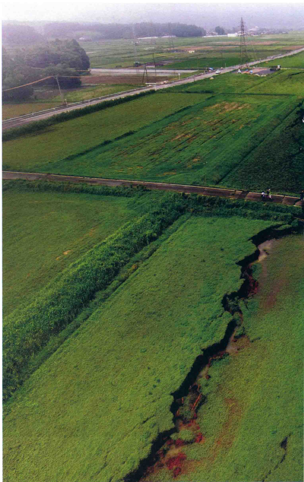
插图 2 阿苏破火山口内产生的同震地表破裂形成的地堑构造。
