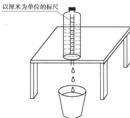
图 1.2 以下液位为主的漏壶计时原理图
