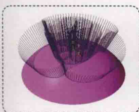
曲线五轴加工刀路
