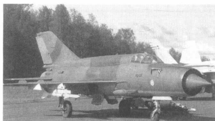
图 1-4 采用超声速轴对称进气道的米格-21 战斗机
