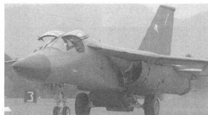
图 1-5 F-111 战斗轰炸机的翼下 1/4 中心锥进气道
