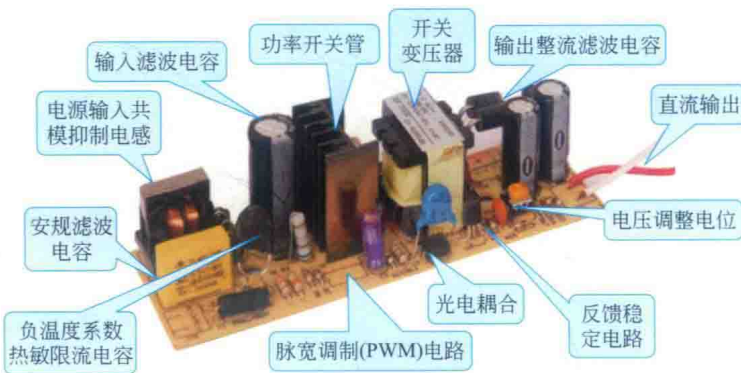
图 1-3 常见电源适配器内部电路板 (2 页)
