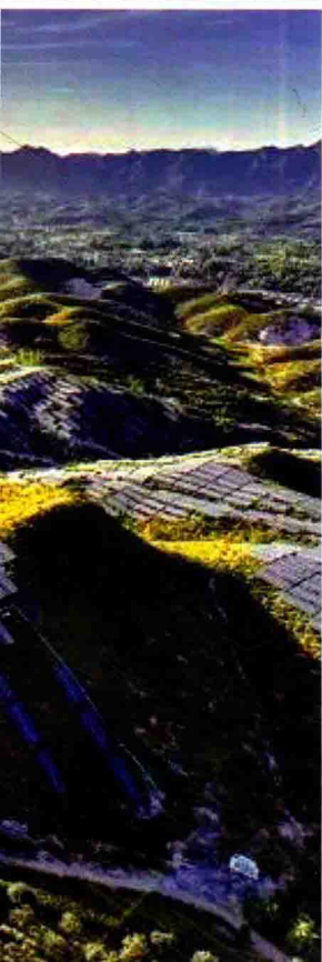
图6 太阳能的利用。云南大理附近朝南的山坡铺满了太阳能电池，接收太阳辐射的能量。不管夏天还是冬天，也不管赤道还是北极，地球上每平方米接收的太阳能年平均为200W。目前单晶硅太阳能电池的光电转换效率为15%左右，最高可达23%，在太阳能电池中光电转换效率最高，单晶硅太阳能电池的使用寿命一般可达15年，最高可达25年。其他种类的太阳能电池（如多晶硅太阳能电池和薄膜太阳能电池）的光电转换效率要低一些。
