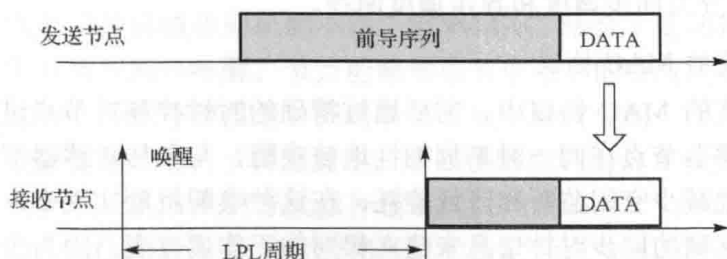
图 1-4 基于前导序列的低功耗监听方式(B-MAC 协议)
