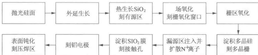
图 1.12 生产 MOS 管的一般步骤
