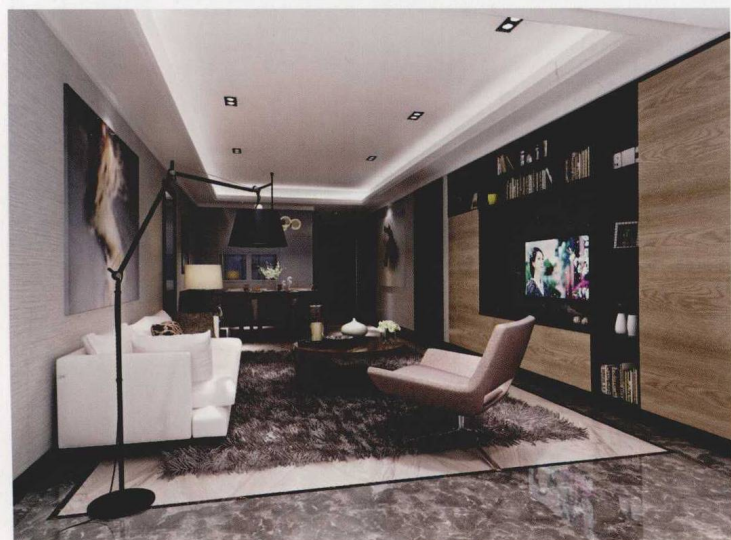
仿石材地砖 + 定制墙面柜 + 石膏板吊顶暗藏灯带
