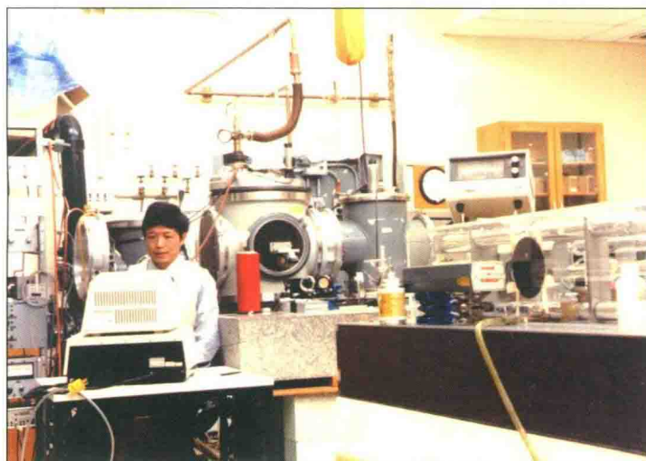
2. 超低温下的激光光谱实验（1986—1989年在加拿大滑铁卢大学和美国普林斯顿大学两实验室用台式PC控制和记录 1.6\text{K} 分子团的激光光谱试验）
