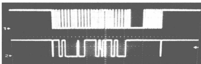
图 1.3 数据读取时无响应信号 ACK
