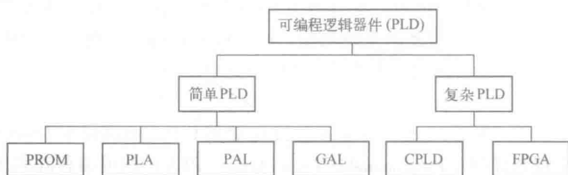
图 1-1 PLD 发展结构示意图
