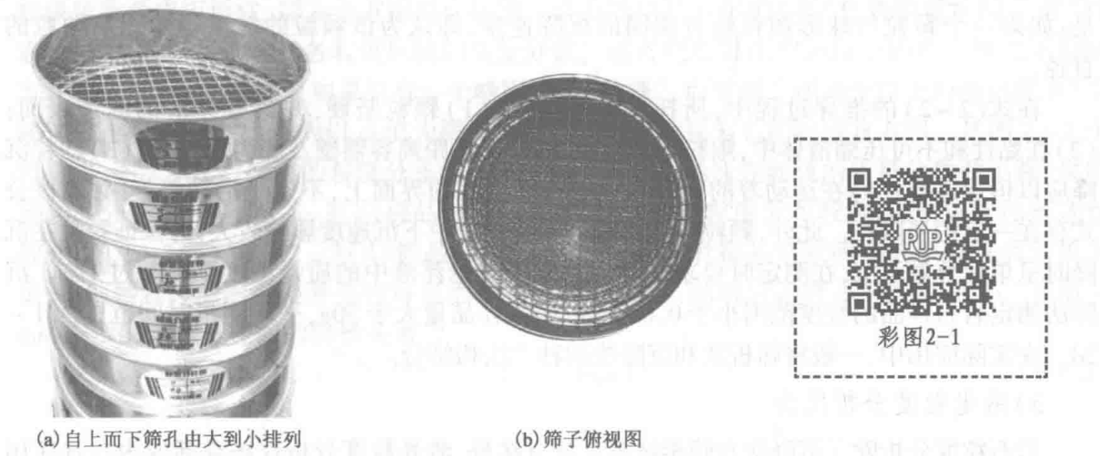
图 2-1 筛析法实验中使用的部分筛子
