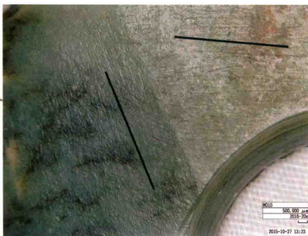
图1-4 小玉璧（编号19818）表面擦痕及摩擦方向
