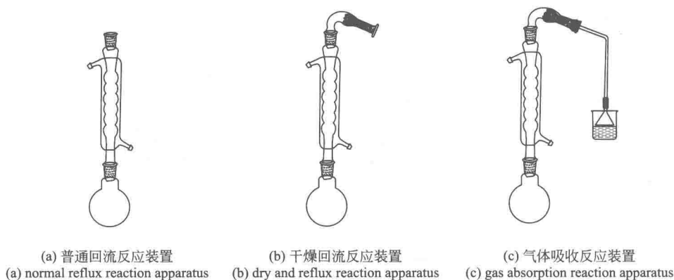
图 1-2 回流反应装置 Figure 1-2 Reflux reaction apparatuses
