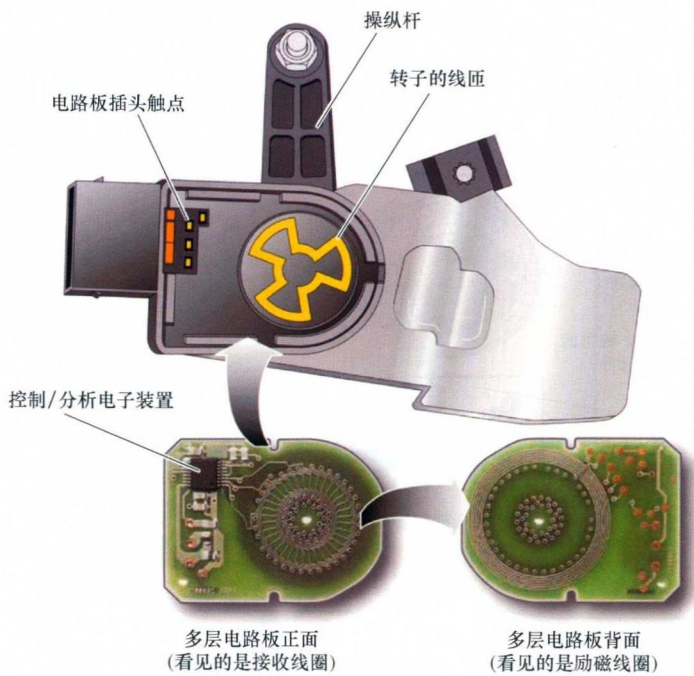
图 0-10 转角传感器结构
