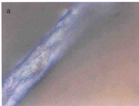
图4-13(彩) 扇套蓝色纤维显微观察(a.×1000倍;b.×2000倍)
