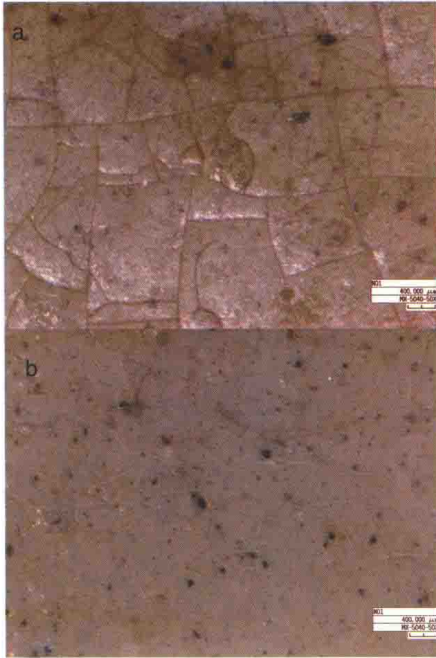
图3-20(彩) 3号样品未腐蚀(a)和腐蚀釉面(b)对比图
