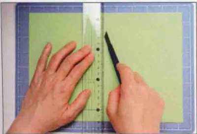
折纸前，用美工刀的刀背轻轻地划出折痕。这样没有褶子，折痕比较容易折。
