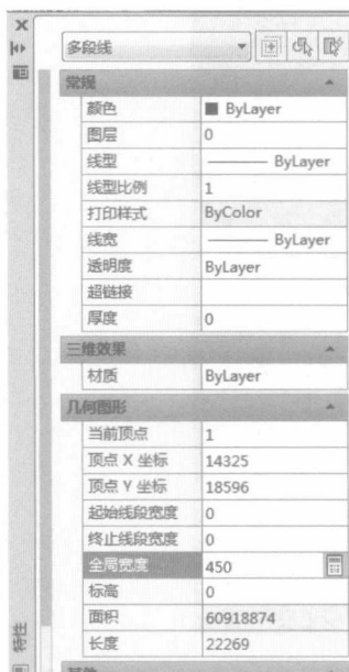
图 1-13 改多段线全局宽度
