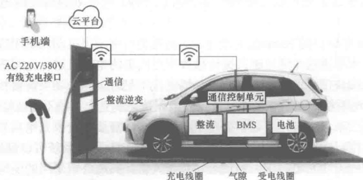
图 1-2 车用双模（有线+无线）充电桩充电原理
