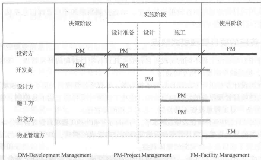
图 1-1 工程项目全阶段的管理
