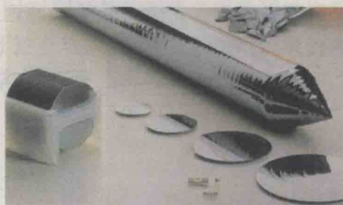
图1-10 半导体硅晶片可用于制造计算机芯片
