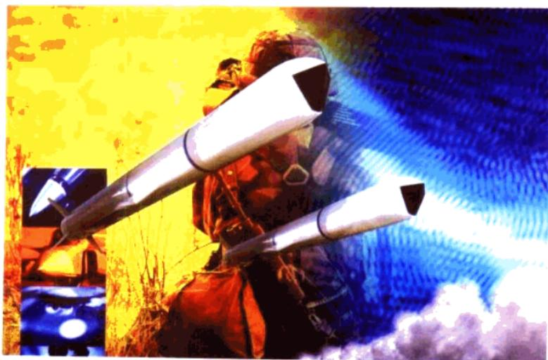
"斯拉姆"增强型导弹是美海军装备的GPS辅助惯性中段制导+红外成像末段制导导弹。采用涡喷发动机,射程200公里。
